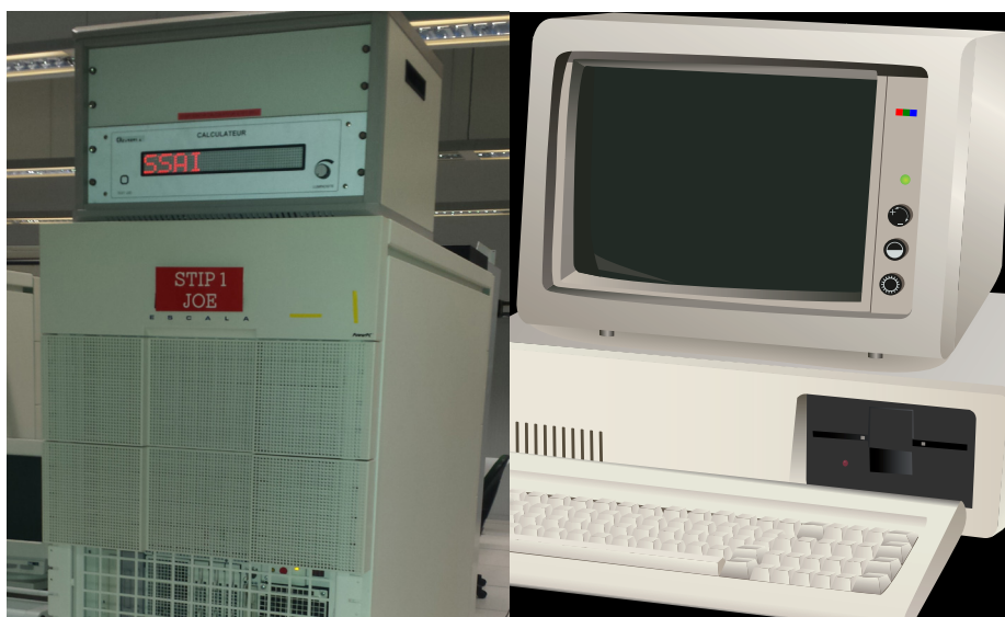
Contemporain des PC à disquette, ce STIP supporte tous les PLN français depuis 2001. Dernier composant CAUTRA qui sera décommissionné, la DSN se demande encore si son portage est nécessaire.
